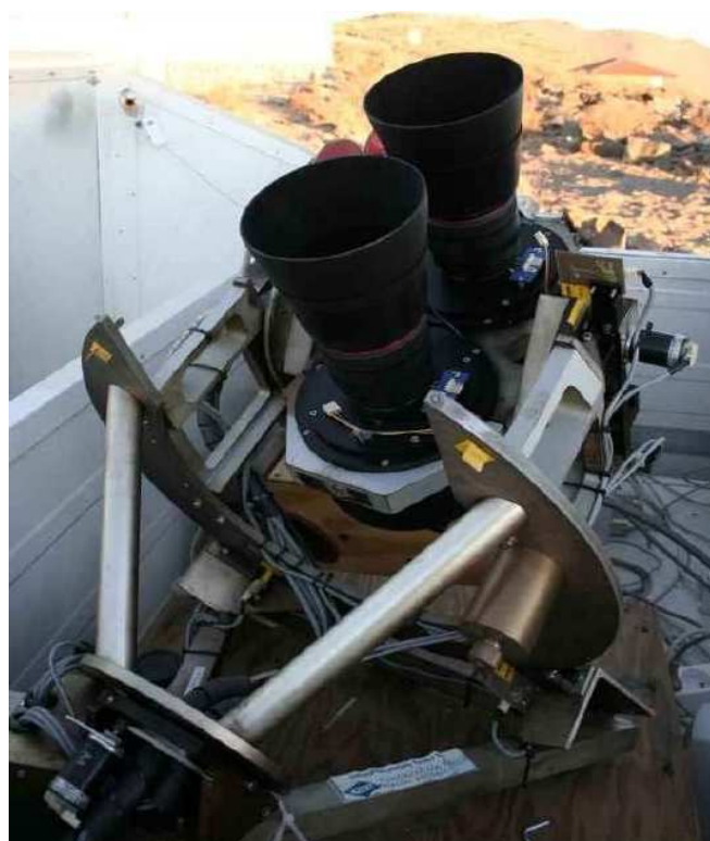
Rysunek 2: Prototypowy system złożony z 2 kamer działający od czerwca 2004 w obserwatorium Las Campanas w Chile
