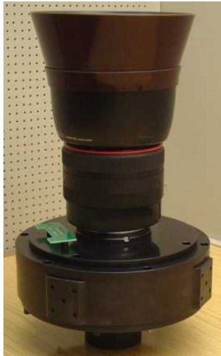
Rysunek 1.1: Kamera CCD skonstruowana na potrzeby eksperymentu „Pi of the Sky”
