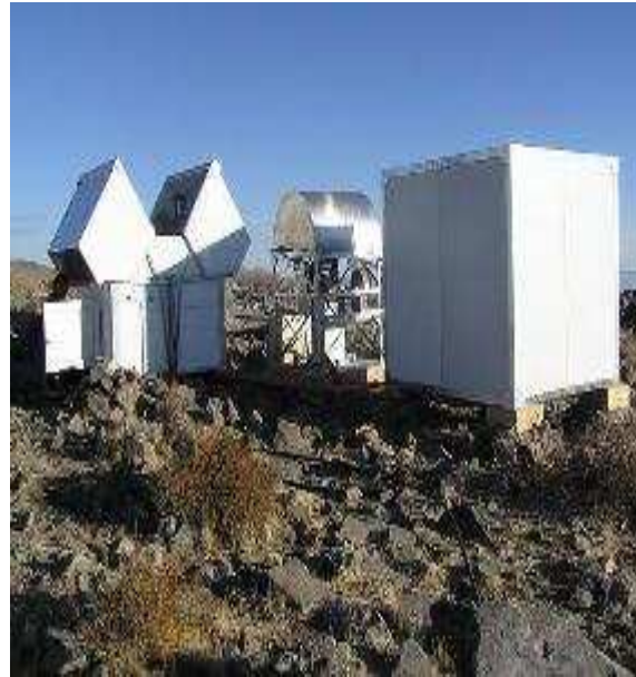
Rysunek 9. Po lewej stronie znajduje się prototyp detektora umieszczony w otwieranej kopule, natomiast po prawej stacja kontrolna z komputerami.
